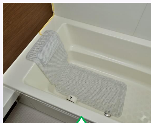
マットセンサーを浴槽に設置
