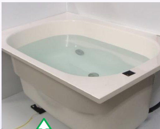
センサーを底下に設置(*2)
