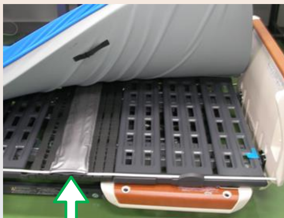
センサーシートをマットレス下に設置
